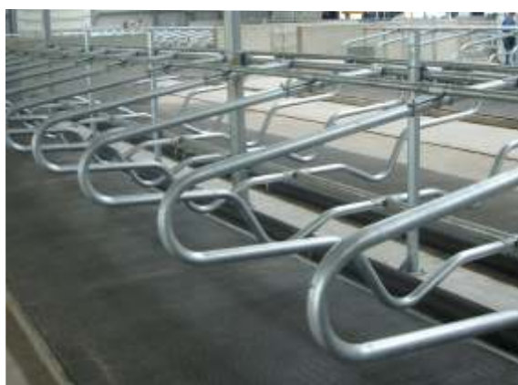
Brustrohrhalter für KS-Rohr 160 mm für Bodenbefestigung
