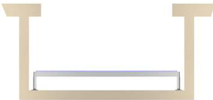
Fester Melkstandboden mit Längsträgern für tiefe Gruben
